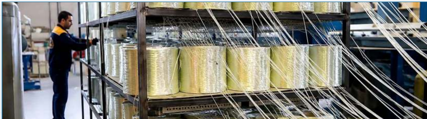
FIG.15-A – قرقره‌های الیاف شیشه پیوسته (Roving) روی خرک تغذیه، پیش از ورود به حمام رزین.
